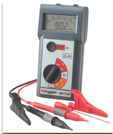
Сл. 6.8: Тестер за изолација и непрекинатост (Megger)
