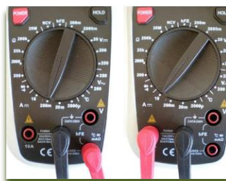
Слика 3.57 Приклучоци на дигитален инструмент за мерење електрична струја
