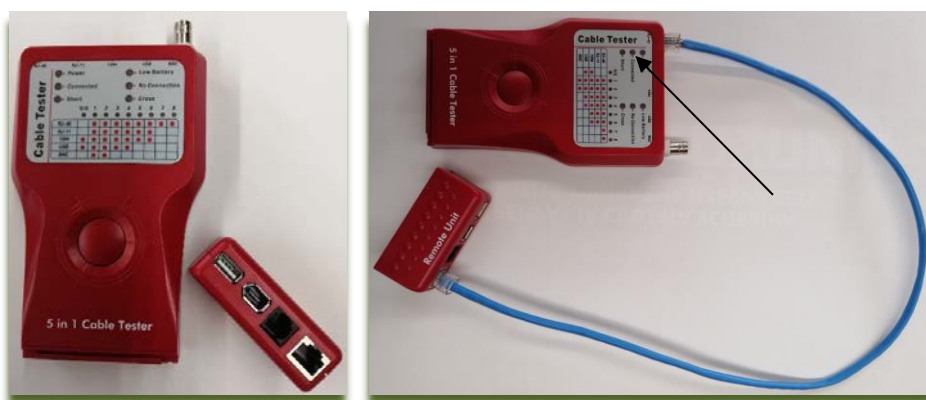
Сл. 6.36 Испитување непрекинатост со тестер на кабел
