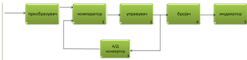
Сл. 3.7 Блок-шема на дигитален мерен инструмент со врамнотежување
