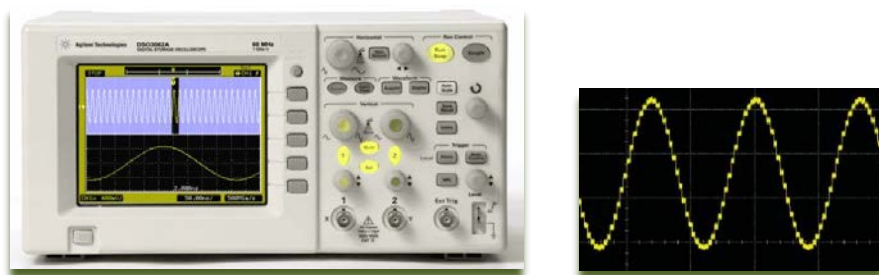
Слика 3.71 Изглед и слика на екран на дигитален осцилоскоп
