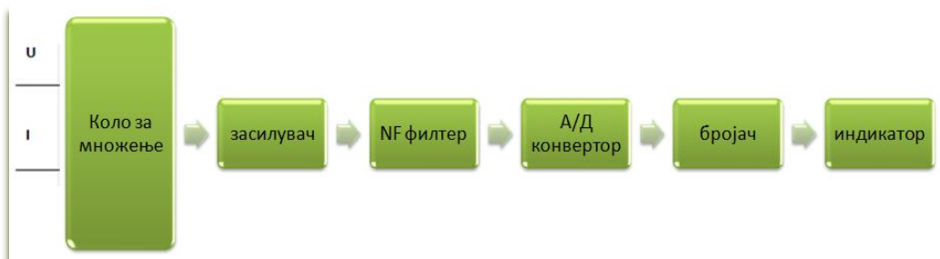
Сл. 3.62 Блок-шема на дигитален ватметар
