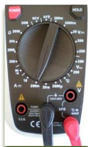
Слика 3.58 Мерење еднонасочна струја со дигитален мултиметар
