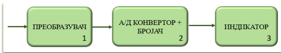
Сл. 3.6 Блок-шема на дигитален мерен инструмент со директна преобразба
