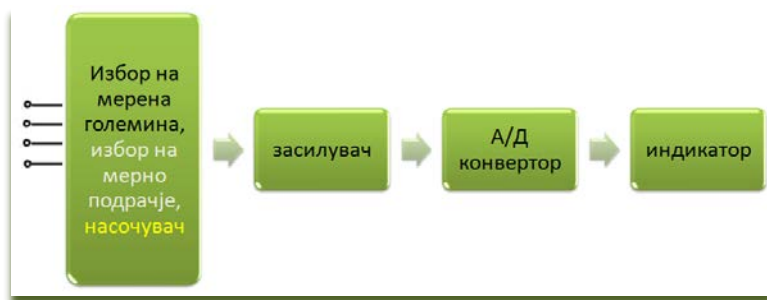
Слика 3.52 Блок-шема на дигитален мултиметар
