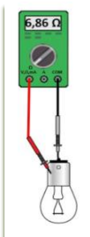
Слика 3.60 Мерење отпорност со дигитален мултиметар струја
