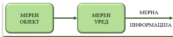
Сл. 1.1: Блок-структура на општ мерен процес
