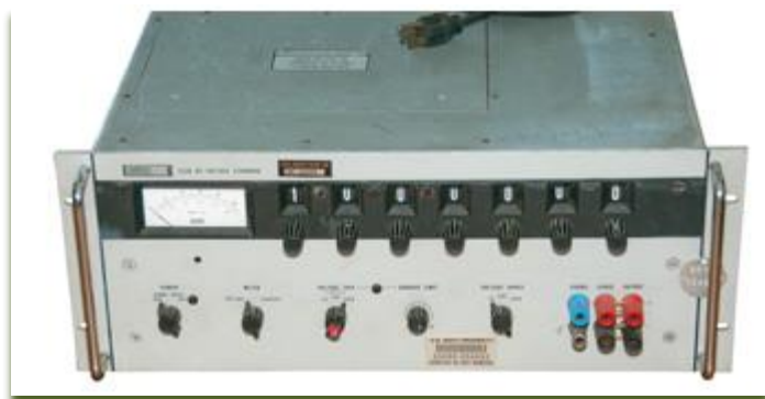
Сл. 1.4: Еталон за еднонасочен напон (FLUKE)
