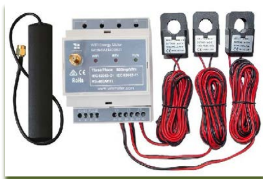
Сл. 3.67 Трофазно дигитално броило со безжичен пренос на регистрирани податоци
