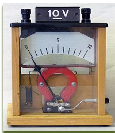
Сл. 2.1 Составни делови на аналоген мерен инструмент
